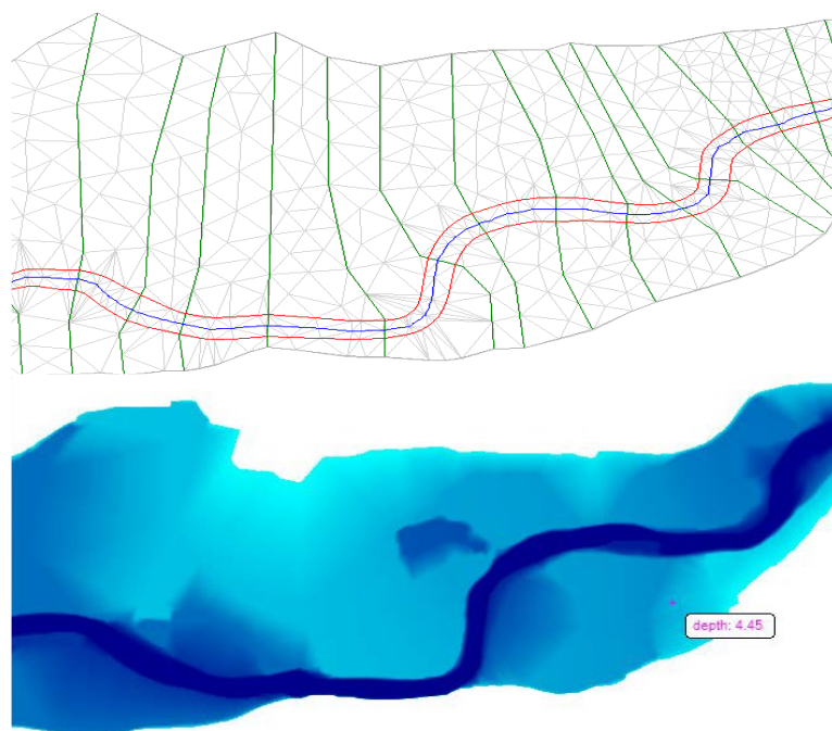
Figura 10 – Seções transversais com as linhas de borda, e mancha de inundação com resultado de profundidades – HEC-RAS
