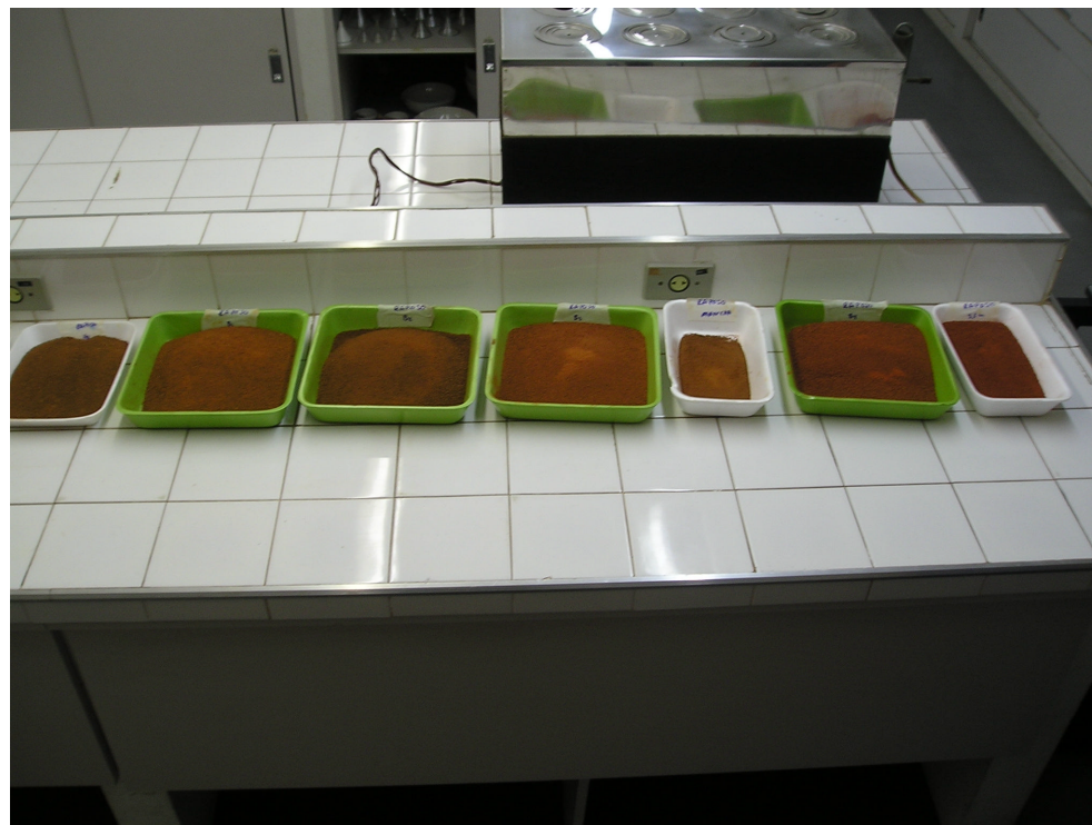
Figura 11: Amostras dos horizontes do perfil de solo, de onde foi coletada a amostra para os ensaios de caracterização agronômica e mineralógica.
