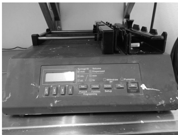
Figura 19 - Bomba Seringa Comercial utilizada para extrusão da camada ativa
