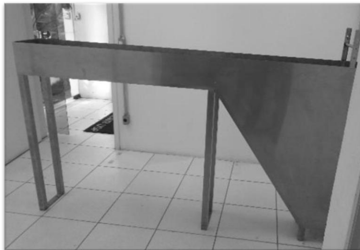
Figura 20 - Tanque para banho de coagulação
