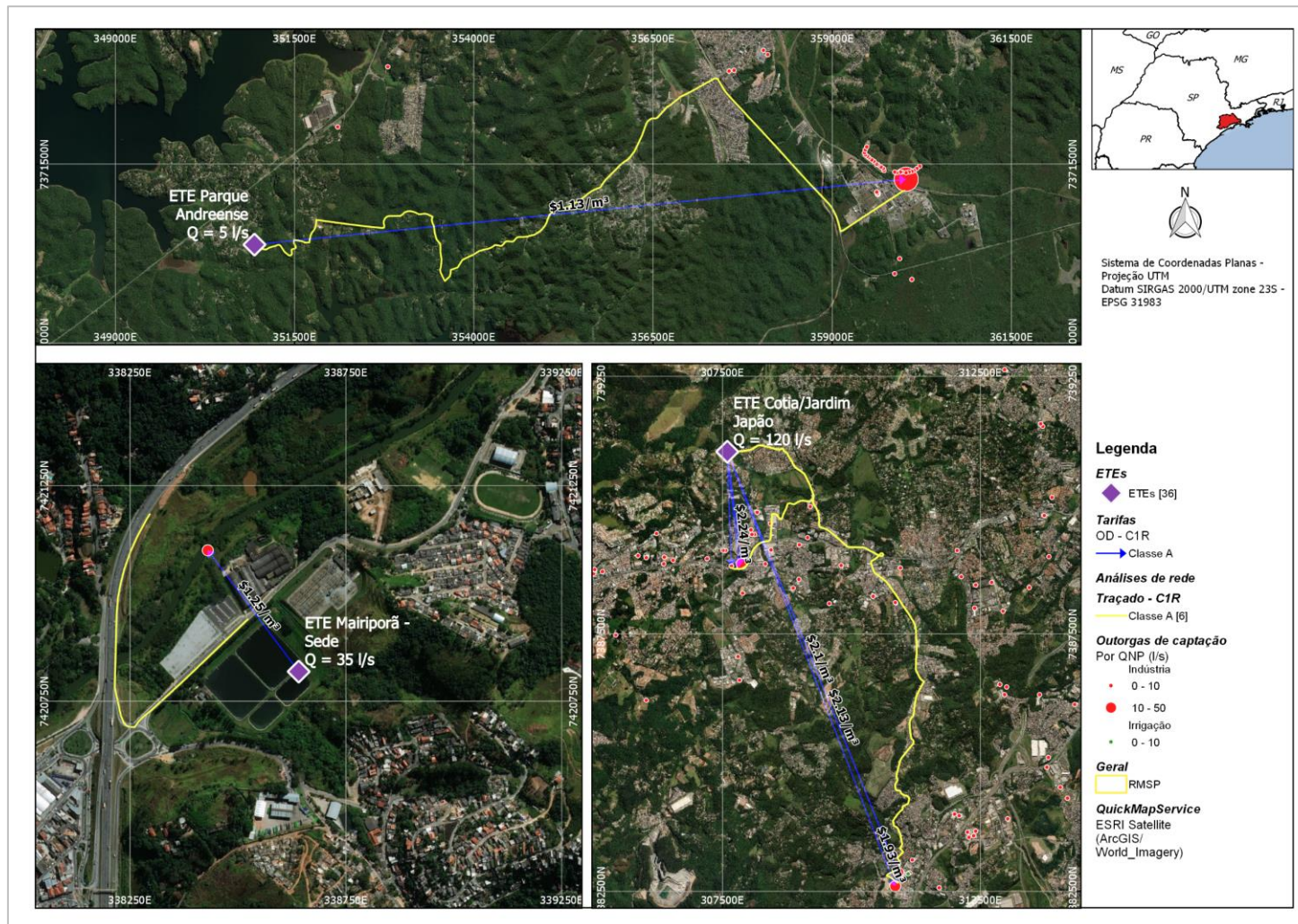
Figura 60: Distribuição dos usuários-âncora em relação à ETEs Parque Andreense, Cotia/Jardim Japão e Mairiporã – Sede para C1R: traçados de adutoras (em amarelo) e OD (origem destino) com tarifas (em azul) Fonte: elaborado pelo autor
