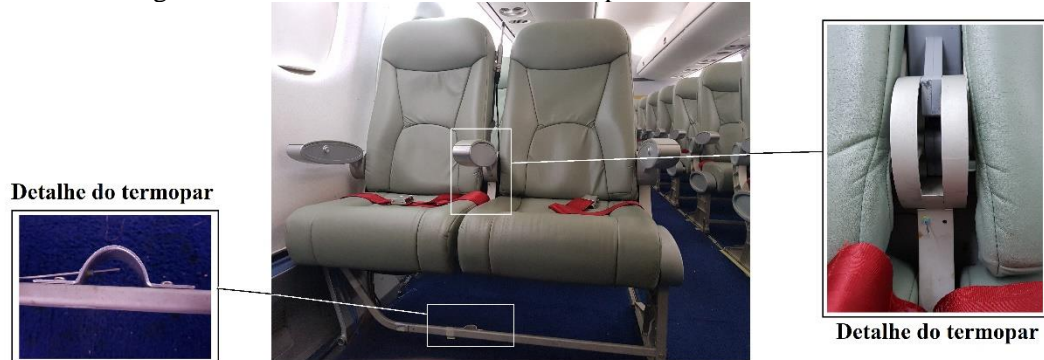
Figura 4.12 – Posicionamento dos termopares nos assentos da cabine
