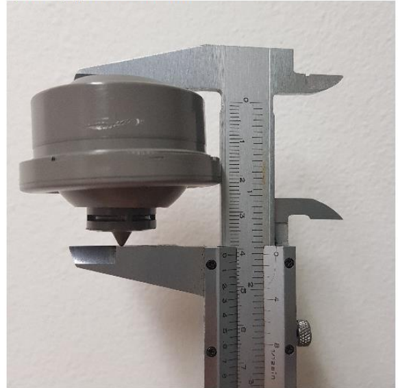
Figura 4.7 – Distância entre o vértice do cone central e a face superior da rótula quando a válvula gasper encontra-se a) totalmente aberta ou b) totalmente fechada
