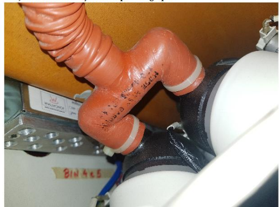
Figura 4.5 – Distribuição de ar das válvulas gasper na área interna dos bagageiros
