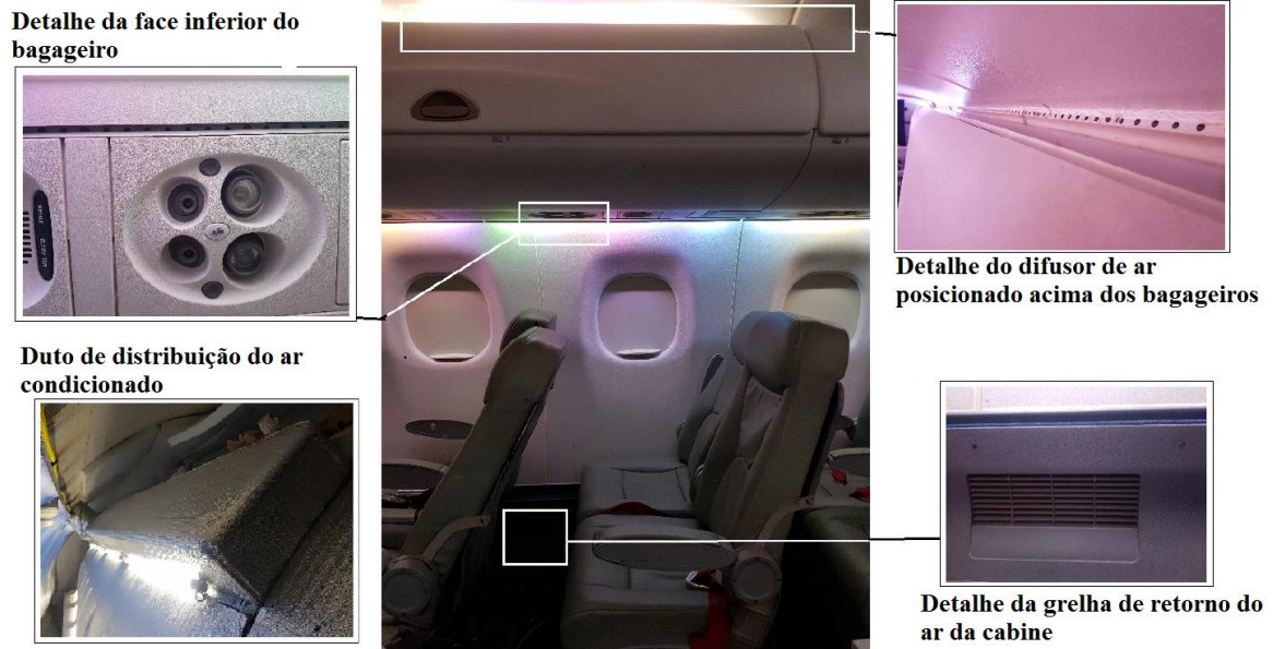
Figura 4.4 – Sistema de ventilação por mistura da cabine
