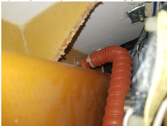
Figura 4.5 – Distribuição de ar das válvulas gasper na área interna dos bagageiros
