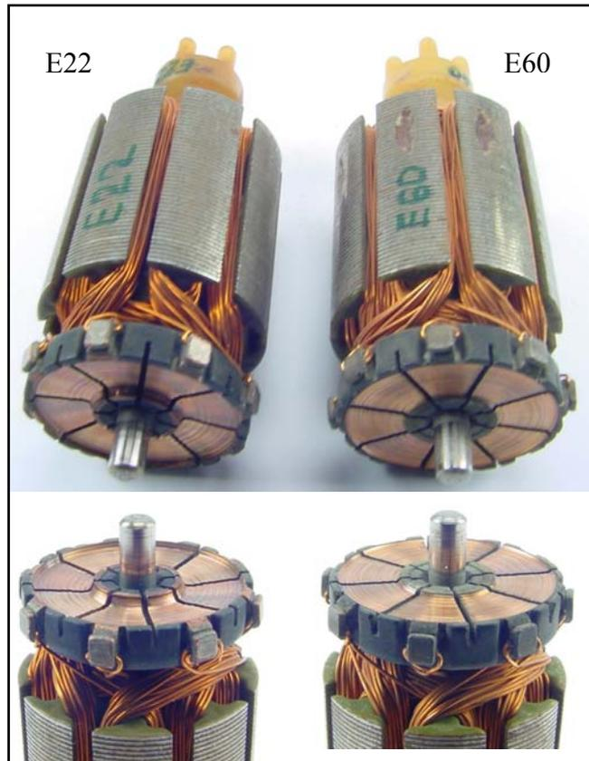
Figura 4.46: Desgaste nos contatos de cobre.
