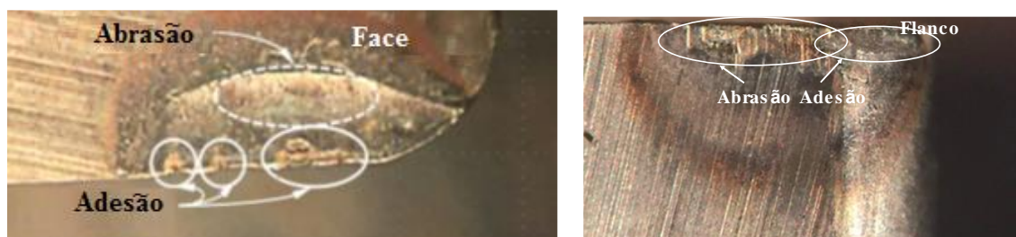
Figura 95 – Exemplo de mecanismo de desgaste lupa estereoscópica: NbC-Ni_967
