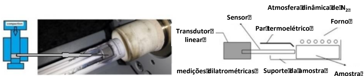
Figura 52 – Esquema da medição da contração linear para obtenção da curva dilatométrica
