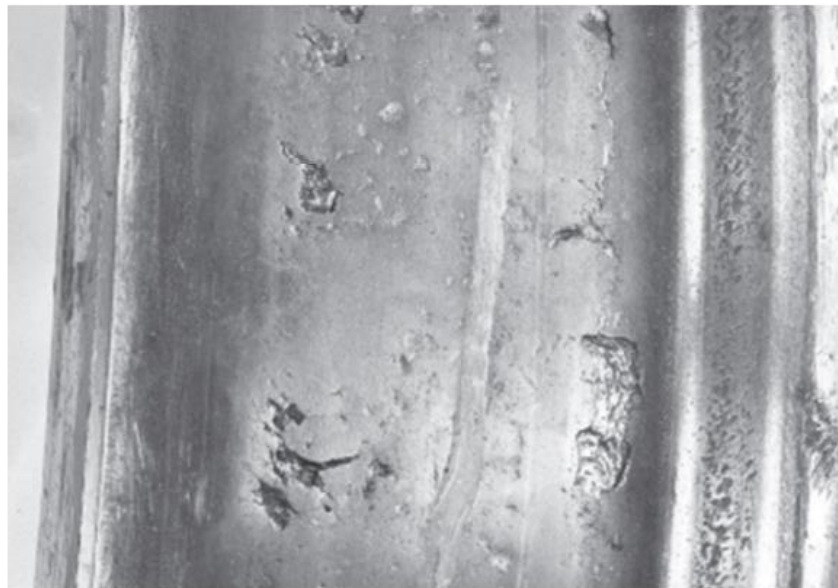
Figura 29 – Danos por fadiga na superfície da roda.
