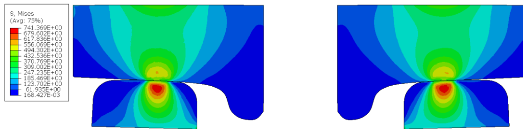
Figura 63 - Distribuição das tensões de von Mises para o caso com rodas AAR Class C e trilho AREMA TR68 de norma.
