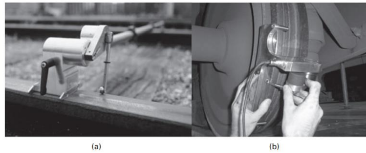
Figura 2 – Dispositivo de medição “MiniProf”: (a) perfil do trilho; (b) perfil da roda.
