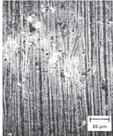
Figura 20 – Ranhuras devido ao desgaste abrasivo.
