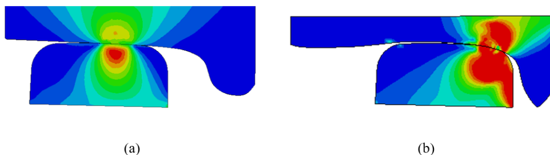
Figura 76 - Distribuição das tensões segundo critério de von Mises para o caso com esforço lateral: a) modelo 2D simétrico e b) modelo 2D não simétrico.
