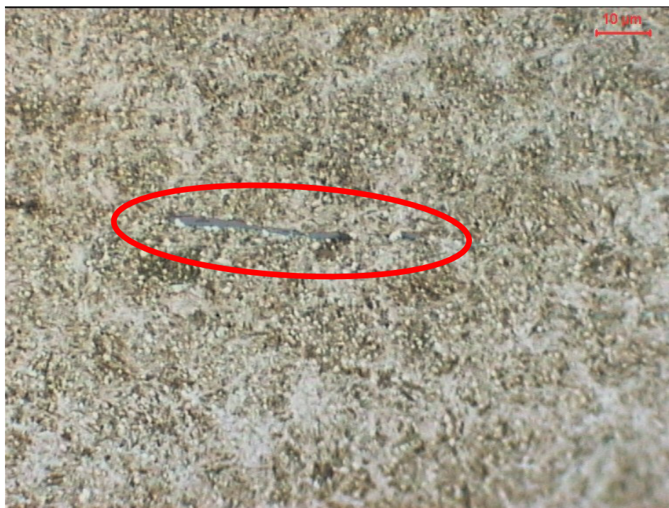
Figura 4.2.4 – Inclusão não metálica encontrada na seção transversal do anel interno do rolamento 1.
