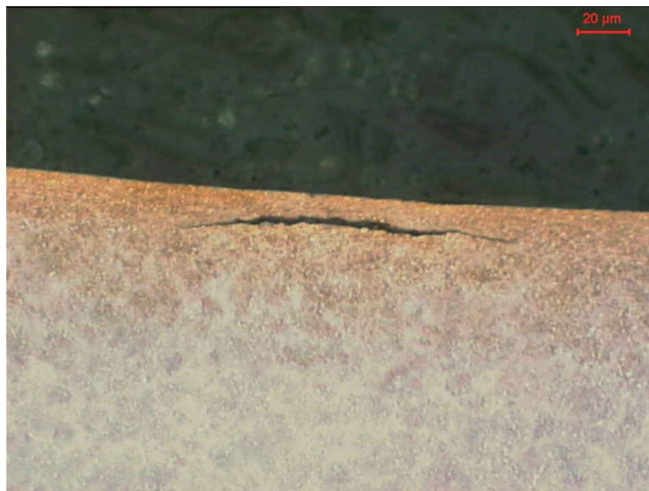
Figura 4.2.8 – Secção transversal do anel interno do rolamento 22 com presença de trinca, localizada na porção esquerda da zona de contato.
