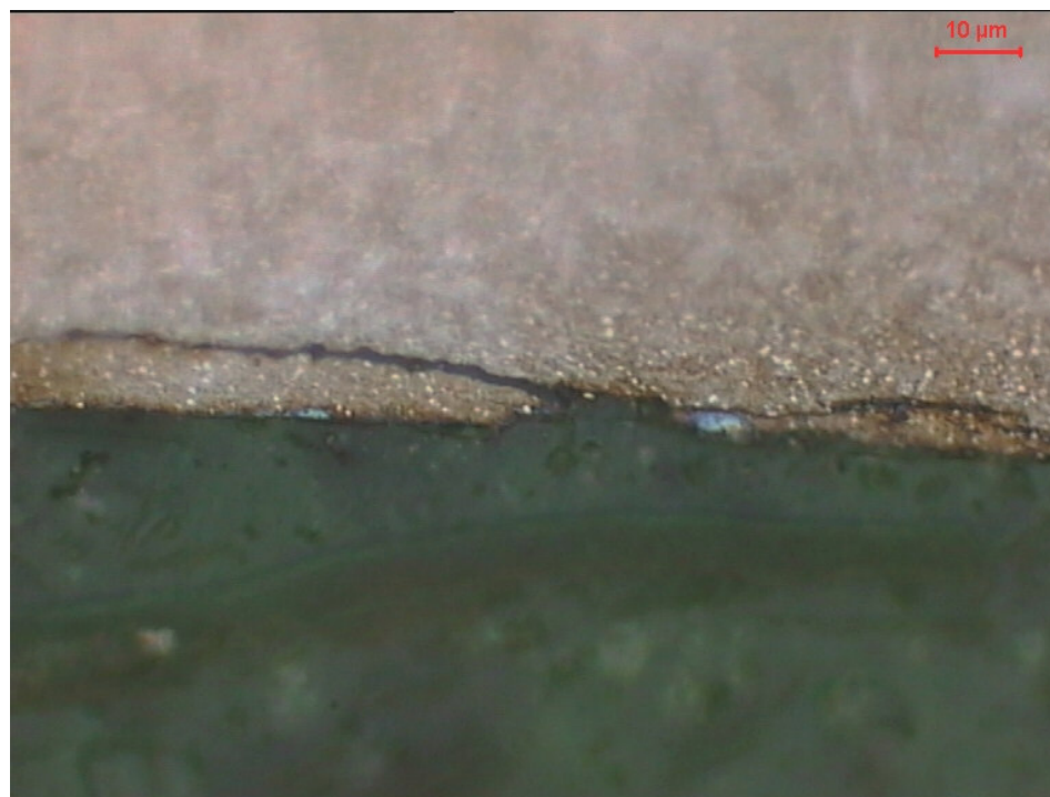
Figura 4.2.7 – Secção transversal do anel interno do rolamento 22 com presença de trinca, localizada na porção central da zona de contato.
