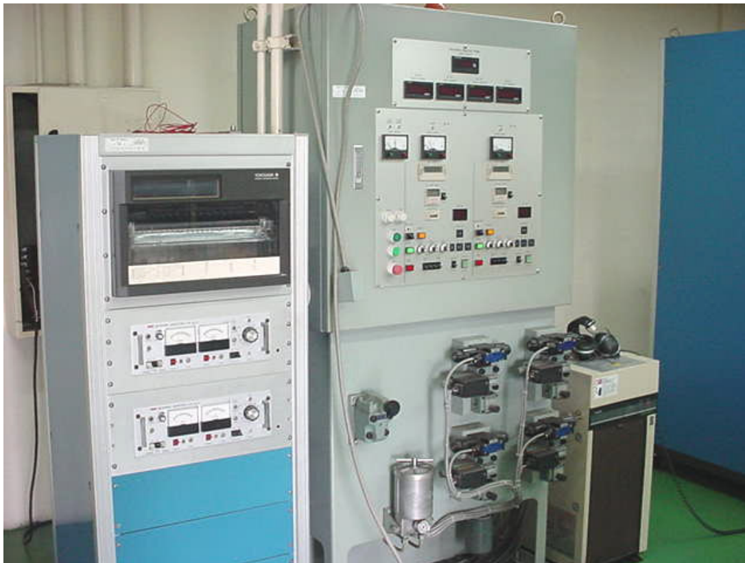
Figura 3.2 – Equipamento utilizado para monitoramento das atividades e aquisição de dados do equipamento utilizado no ensaio.
