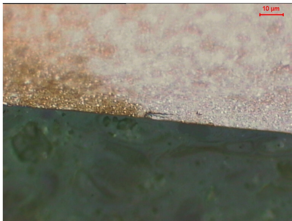
Figura 4.2.9 – Secção transversal do anel interno do rolamento 22 com presença de trinca, localizada na porção direita da zona de contato.
