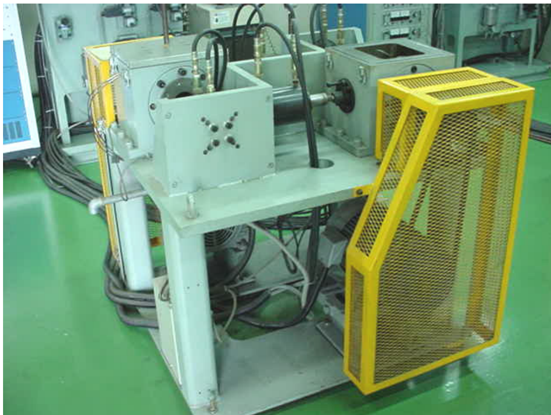
Figura 3.1 – Equipamento utilizado nos ensaios de vida dos rolamentos.
