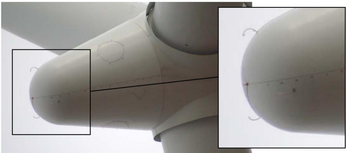
Figura 17 - Spinner da turbina eólica Siemens 3.6MW e detalhe de anemômetros sônicos
