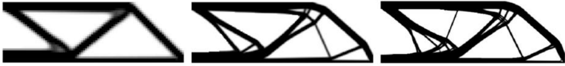
Figura 32 – Ilustração do efeito de dependência de malha.
