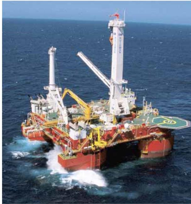
Figura 1.2: Plataforma do tipo semi-submersível. Imagem disponível em (MARINE LOG, 2010).
