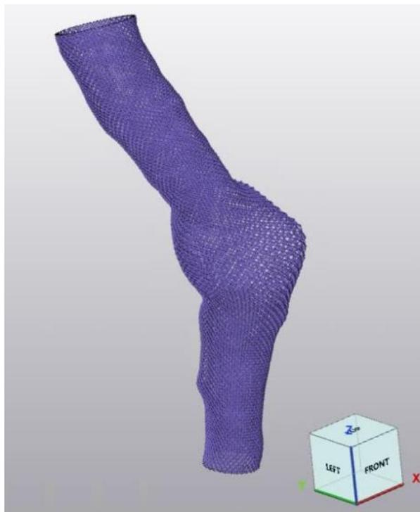
Figura 80 – Resultado da função “UV Based Conformal Lattice”. Fonte: própria do autor, captura de tela do 3-matic®.
