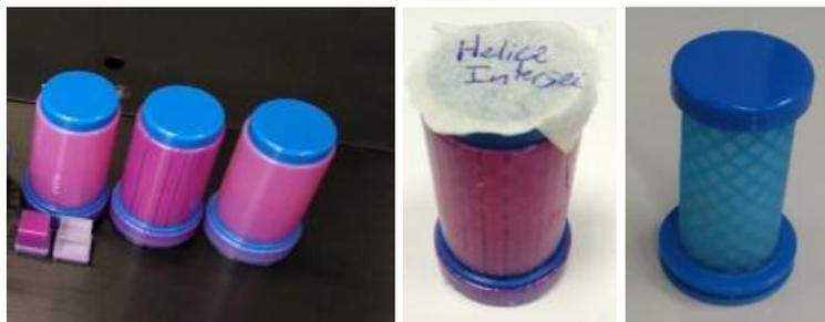
Figura 46 – Da esquerda para a direita: foto da impressora após impressão do quarto conjunto, foto do cilindro com reforço “helicoides interseccionantes” antes e depois da limpeza. Fonte: própria do autor.
