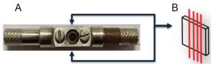
Figura 12: (A) Preparação das fibras capilares virgens no porta amostra de USAXS/SAXS/WAXS. (B) Ilustra a disposição das fibras no porta amostra.
