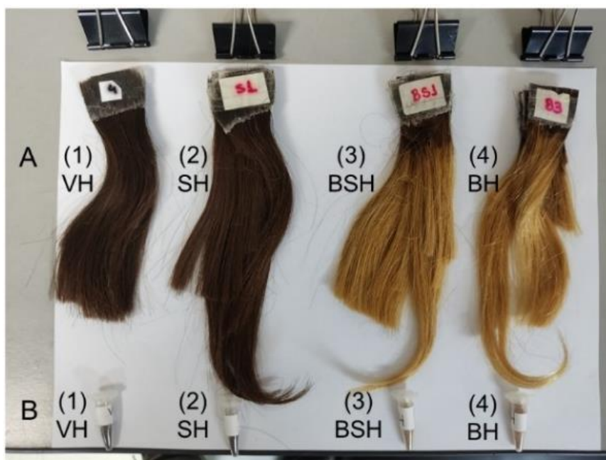
Figura 24: (A) As mechas utilizadas para o experimento de DSC; (1) corresponde ao cabelo virgem (CV ou VH), (2) relaciona-se ao cabelo alisado (CA ou SH), (3) identifica o cabelo alisado/descolorido (CAD ou BSH) e (4) numera o cabelo descolorido (CD ou BH). (B) Os quatro eppendorfs enumerados de 1 a 4 com cabelos VH, SH, BSH e BH respectivamente, cartados e etiquetados.
