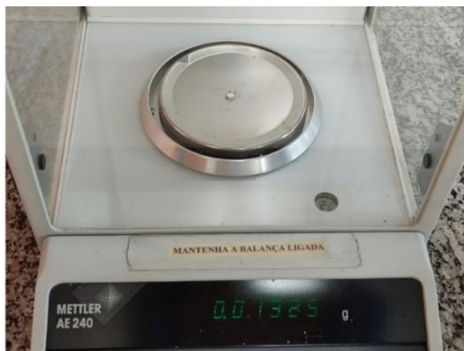
Figura 25: A balança analítica utilizada para aferir as massas dos conjuntos (cadinho e tampa) e cabelos apenas.
