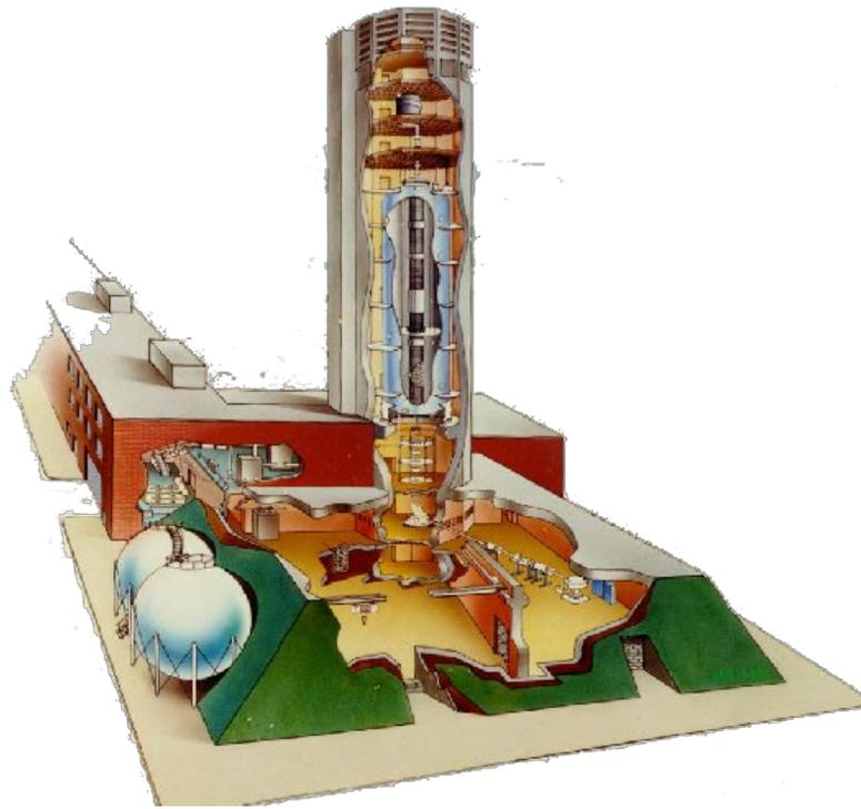
Figura 3.1: Representação do Laboratório TANDAR, destacando desde a fonte de íons no topo até a linha experimental no canto inferior direito.
