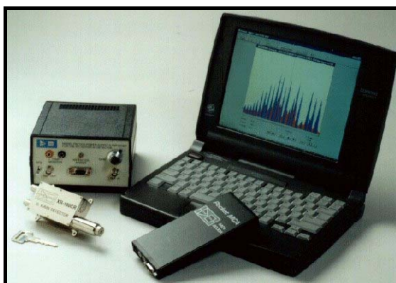
Figura 3-2: Espectrômetro modelo XR-100T-CZT com pré-amplificador de carga A-250 e fonte de alta tensão AC modelo PX2T-CT, fabricados pela empresa Amptek [Amptek, 2001].
