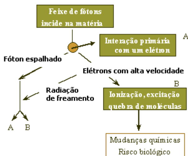
Figura 4-5: Diagrama esquemático da absorção de energia em um meio [Johns e Cunningham, 1983].
