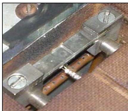
Figura 3-14: A figura da esquerda apresenta o porta-amostra tipo gaveta do aparelho leitor de TL construído no Laboratório de Dosimetria do IFUSP. A figura da direita é uma ampliação da figura da esquerda com destaque para a liga de platina ("panela").
