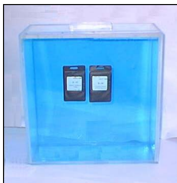
Figura 3-16: Simulador de paralelepípedo de PMMA repleto de água ( 30 \times 30 \times 15 \text{ cm}^3 ) com a espessura da parede frontal igual a 2,5 mm e a espessura das demais paredes (lateral, traseira, base e tampo) igual a 10,0 mm. Para destacar o formato do simulador misturamos corante azul à água no seu interior. Na parede frontal estão afixados os monitores de radiação ( badges ).
