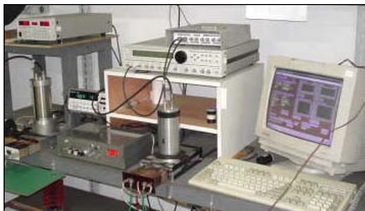
Figura 3-13: Aparelho leitor de TL construído no Laboratório de Dosimetria do IFUSP.
