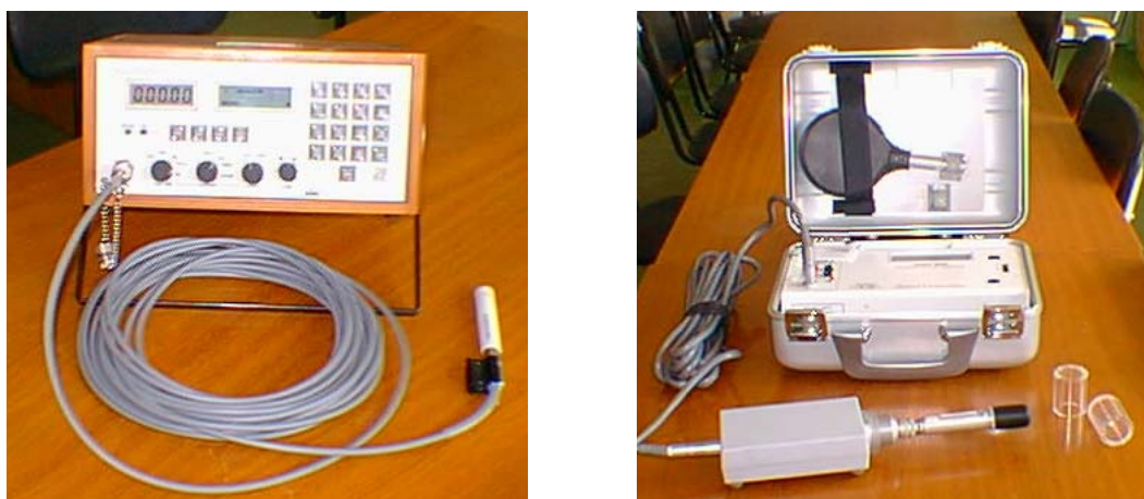
Figura 3-6: À esquerda está o dosímetro Farmer, modelo 2570 A, série 666, da empresa Nuclear Enterprises Ltd com sua câmara de ionização tipo dedal, modelo 2571, série 1103 coberta pela capa de equilíbrio eletrônico. À direita, está a unidade de controle de Radiação modelo 9015 da câmara de ionização da empresa Radcal Corporation. Ao lado da unidade de controle está o conversor modelo 9060 acoplado a câmara de ionização, tipo dedal 10x5-6 e ao seu lado está sua capa de equilíbrio eletrônico de PMMA com espessura de parede de 5,0 mm. Na parte superior da figura, presa ao suporte, está a câmara de ionização modelo 10x45-180.
