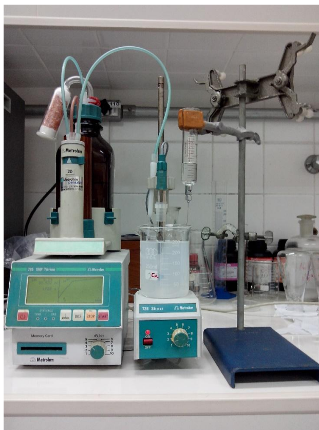
Figura 4.3. Arranjo experimental montado no Laboratório de Nanomateriais e Aplicações (LNA-IFUSP) para preparação de LDHs. Síntese em andamento: titulador automático, seringa para gotejamento e solução de LDHs em síntese.
