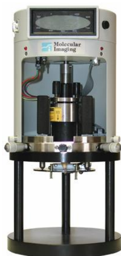
Figura 4.1: Equipamento PicoScan SPM I, utilizado para avaliações e obtenção das imagens de alta resolução.
