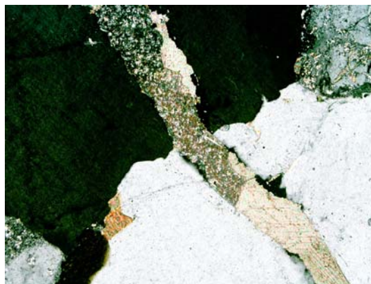
FOTO 2.2: Fotomicrografia exemplo de estado microfissural transgranular; microveio de carbonato.
