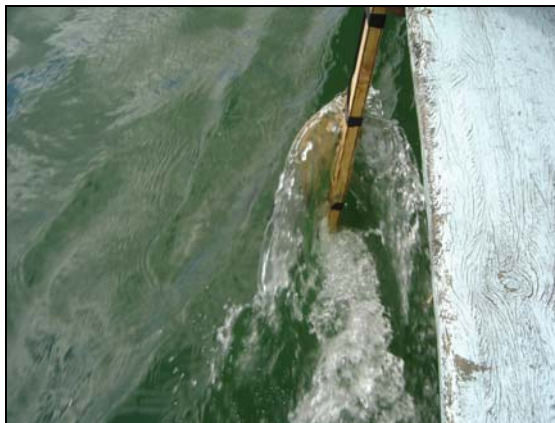
FIGURA 6.3-1 - Detalhe do transdutor do eco-batímetro adaptado na lateral da embarcação em navegação com velocidade acima de 5 km/h. Turbulência junto ao sensor favorecendo ocorrências de ruídos nas leituras da batimetria.
