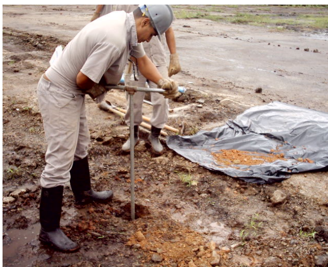
Figura 4.2 – Perfuração para amostragem de solo e instalação de poço (P-03).
