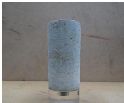
Figura 4.4 – Corpo de prova usado no ensaio BE.
