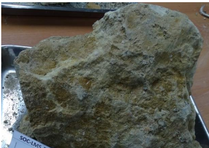
Figura 2 – Amostra indeformada de argila dura cinza-esverdeada usado nos ensaios do presente estudo.
