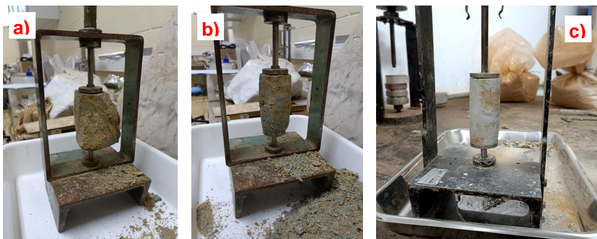
Figura 4.2 – Processo de moldagem de corpo de prova para o ensaio triaxial: a) início da moldagem do corpo de prova; b) redução do diâmetro do corpo de prova para as medidas do ensaio; c) corpo e prova ao término da moldagem.
