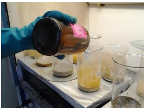
Figura 11 - Ataque à matéria orgânica presente nas amostras de sedimento de fundo após a adição de água oxigenada.
