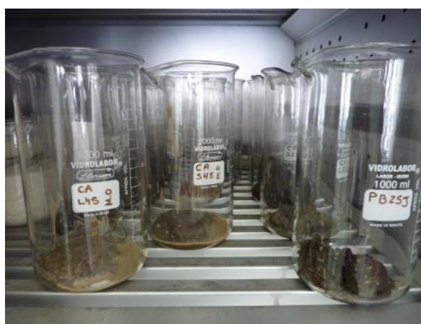
Figura 10 - Amostras úmidas de sedimento de fundo em estufa à 60 °C) para a secagem (peso seco)
