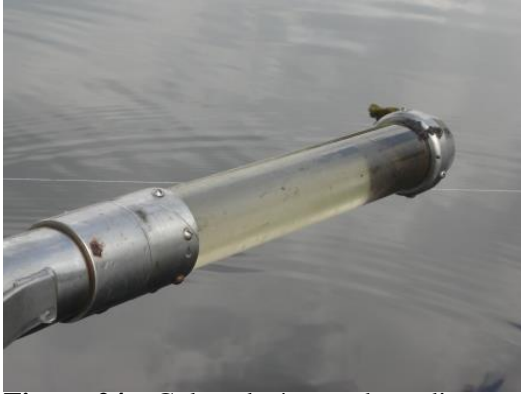
Figura 24 – Coleta de água e de sedimentos de fundo
