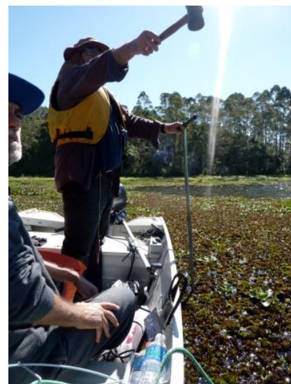
Figura 23 - Fixação do coletor Kajack Brinkhust para a coleta de água e sedimento de fundo
