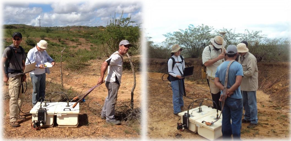
Figura 11 - Levantamento GPR com antena de 100 MHz.
