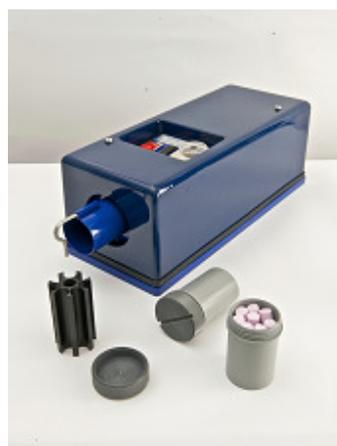
**Figura 3.11.** Micronizador e recipiente com cilindros de cerâmica aluminosa
