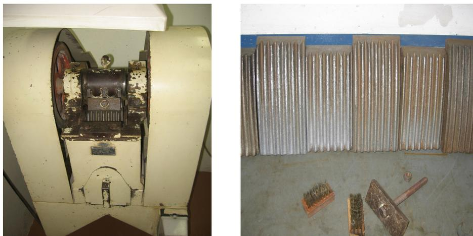
**Figuras 3.4.a e 3.4.b.** Britador primário e acessórios (mandíbulas)
