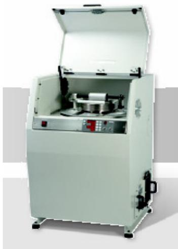
**Figura 3.9.** Equipamento para o moinho de anéis
