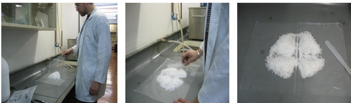
**Figuras 5.6.a, 5.6.b e 5.6.c.** Processo de homogeneização e quarteamento em cone
