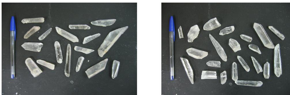
**Figuras 5.1 e 5.2.** Amostra de quartzo antes e depois do procedimento de limpeza, respectivamente
