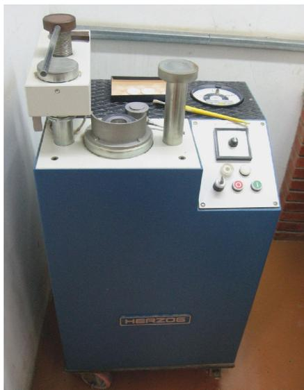
**Figura 3.12.** Prensa hidráulica para confecção de pastilha de pó prensado
