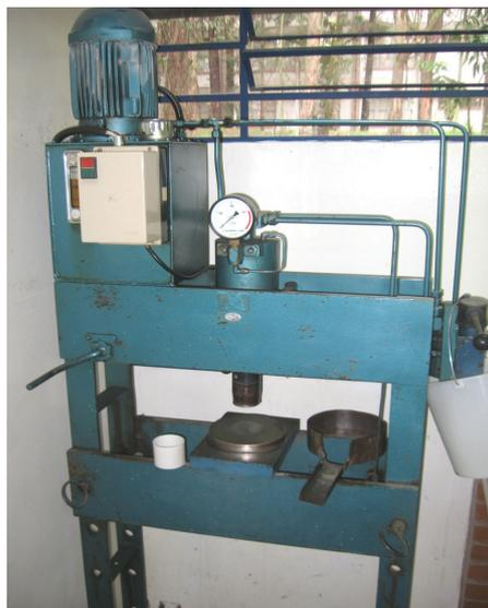
**Figura 3.6.** Equipamento de prensa hidráulica
