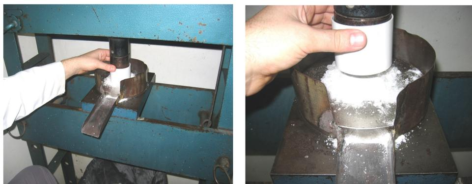
**Figuras 5.11.a e 5.11.b.** Etapas de tratamento da amostra de quartzo na prensa de aço
