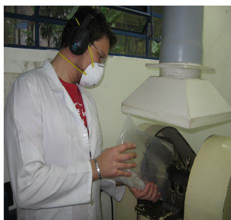
**Figuras 5.5.a e 5.5.b.** Tratamento da amostra de quartzo no britador primário
