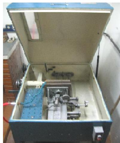
**Figuras 3.2.a e 3.2.b.** Equipamentos de corte com disco diamantado
