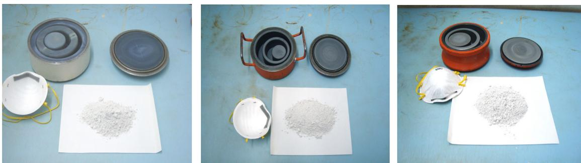
**Figuras 5.7.a, 5.7.b e 5.7.c.** Moinhos de anéis de ágata, carbeto de tungstênio e de aço-cromo, respectivamente
