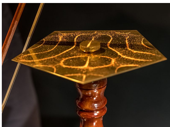
Figura 1: Linhas nodais para uma placa pentagonal geradas experimentalmente. Fonte: Matemateca (IME/USP)/Rodrigo Tetsuo Argenton.
