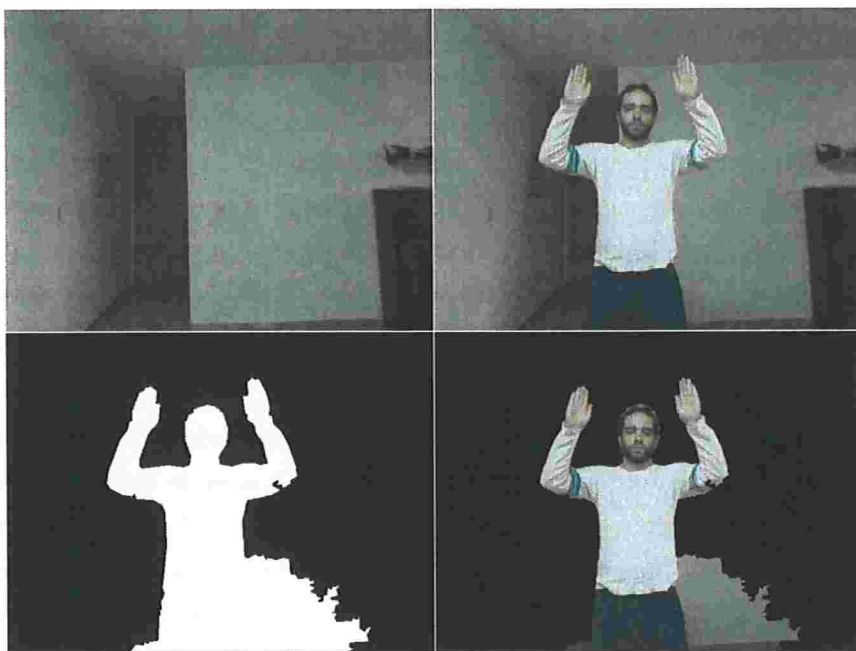
Figura 5.11: Exemplo de segmentação de fundo utilizando-se o algoritmo CB. À cima à esquerda: imagem do fundo. À cima à direita: imagem do fundo mais usuário. Abaixo à esquerda: máscara de segmentação gerada pelo algoritmo. Abaixo à direita: combinação da máscara com a imagem do usuário na cena.
