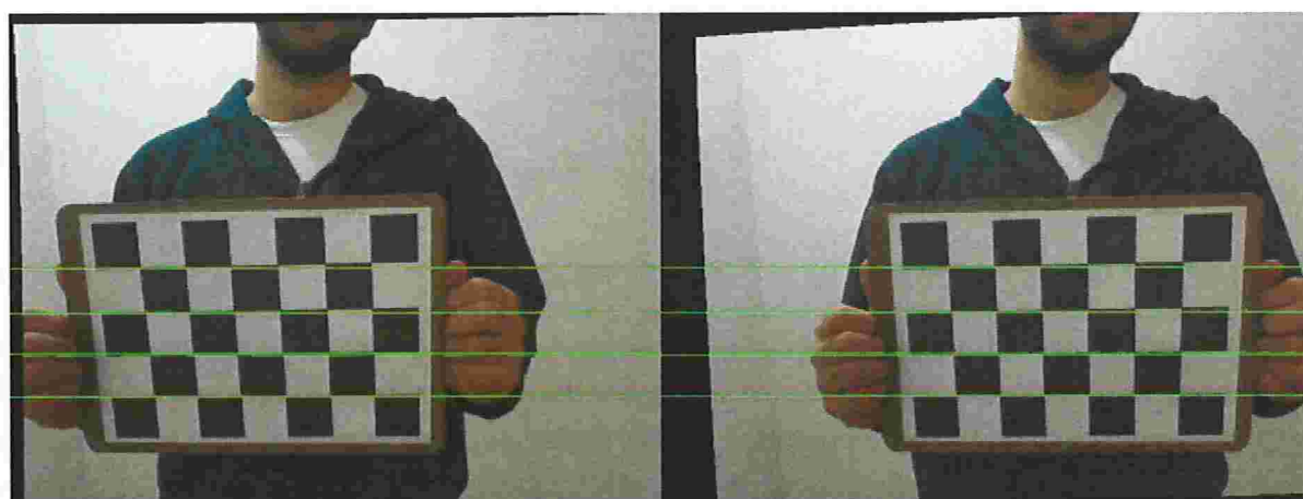
Figura 5.10: Resultado da retificação das imagens em estéreo utilizando o algoritmo descrito.
