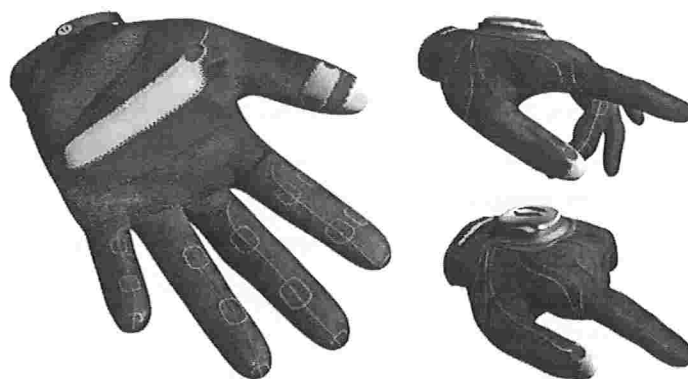
Figura 3.2: Luva de dados Peregrine apresentando, à esquerda, seus três pontos de contato na palma da mão e no polegar e outros pontos ao longo dos demais dedos. À direita são apresentadas algumas conexões entre os dedos e palma da mão.
