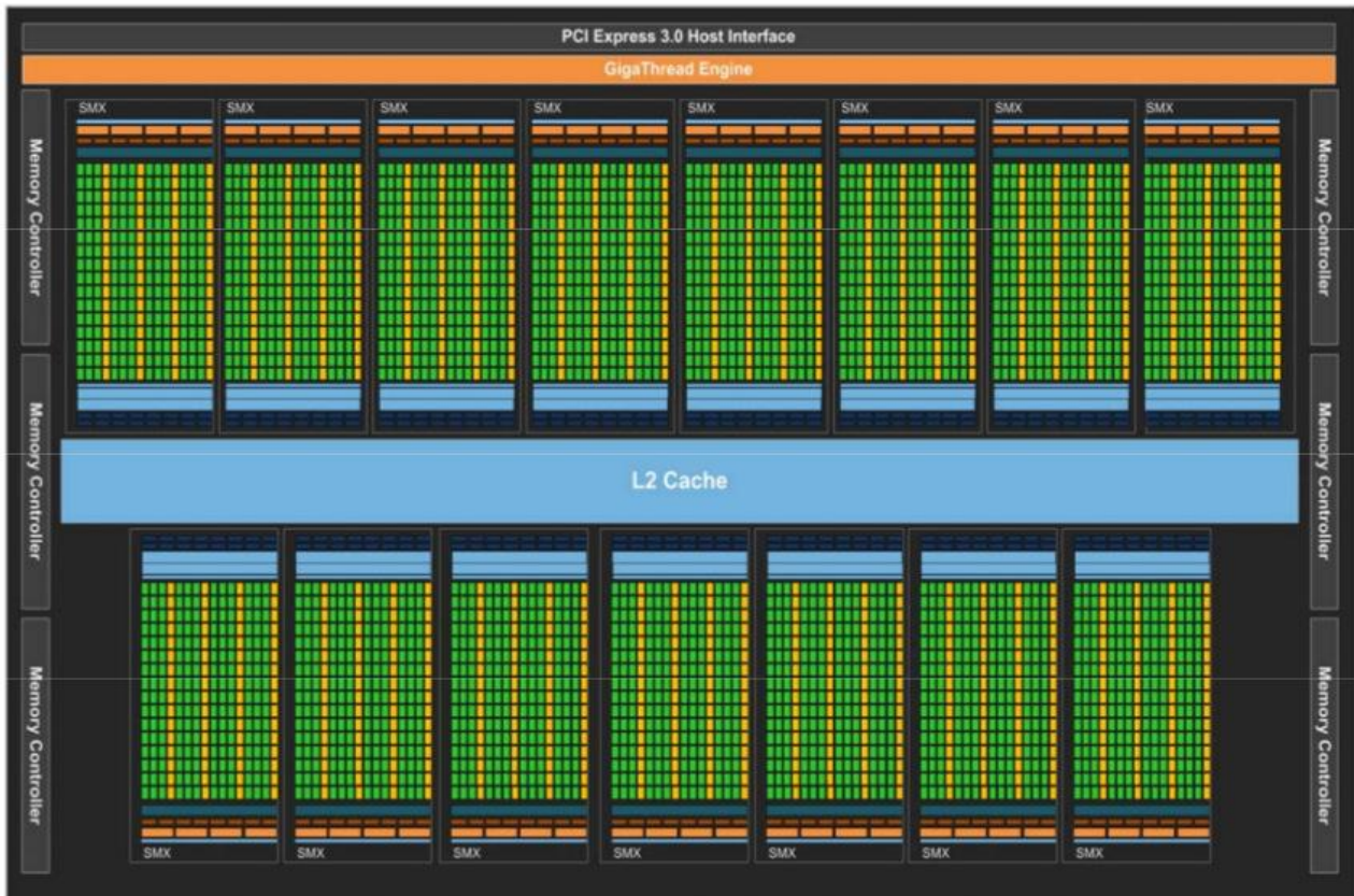
Figura 2.10: Arquitetura das placas gráficas Kepler GK110 e GK210[12].
