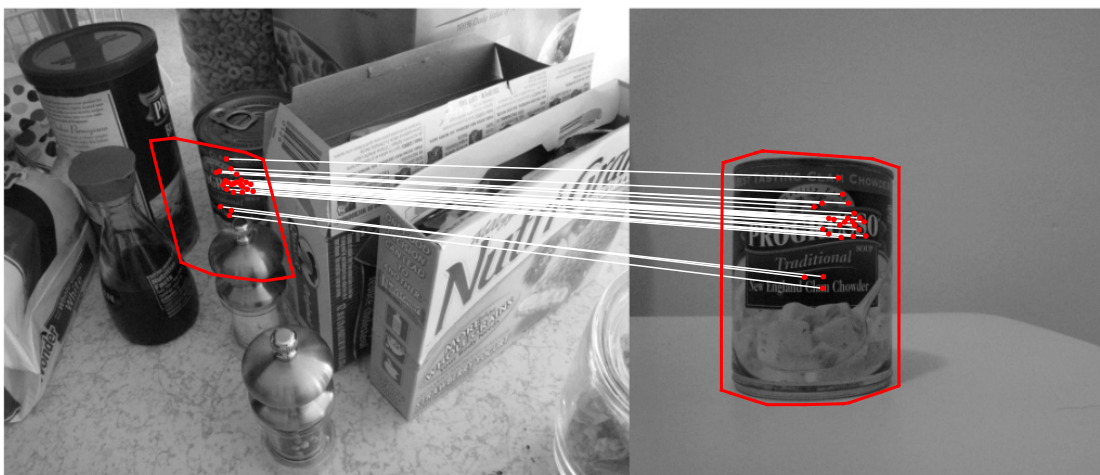
Figura 4.5: Correspondências entre pontos-chave que “concordam” com a transformação afim encontrada. O coeficiente de sobreposição calculado foi 0.42.
