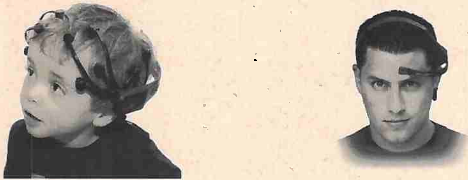
Figura 2.5: Interfaces que utilizam a tecnologia de eletrodos secos: Emotiv EPOC (esquerda) e Neurosky Mindwave (direita).
