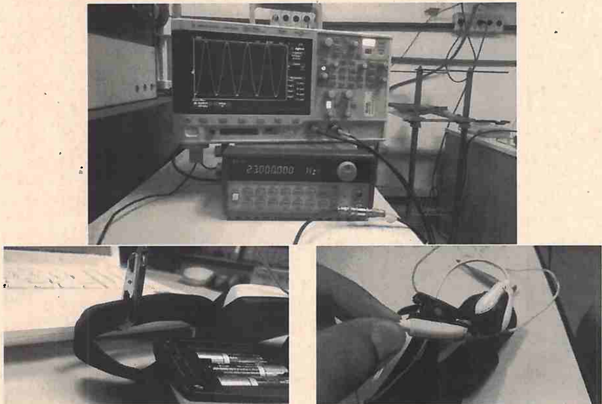
Figura 3.1: Gerador de função HP 33120A Function / Arbitrary Waveform Generator 15 MHz e osciloscópio utilizados no experimento (Acima). Conexões do gerador de função com o eletrodo e com as referências da interface Mindflex (Abaixo).
