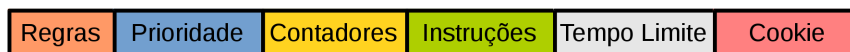
Figura 2.9: Campos que constituem as entradas nas tabelas de fluxo a partir da versão 1.3 do OpenFlow (ONF, 2012)
