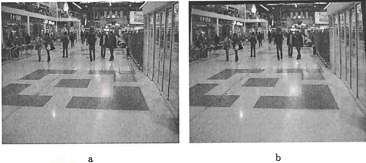
Figura 4.5.1: Exemplo de imagem retificada. (a) Imagem onde o ponto ideal \mathbf{v}_Z é um ponto finito. A retificação é obtida através de uma transformação projetiva que mapeie \mathbf{v}_Z para um ponto no infinito (0, f, 0)^\top . (b) Imagem obtida após a transformação. Ela equivale a um plano de imagem ortogonal ao plano do solo \Pi . Note como as bordas das janelas se tornam paralelas ao eixo das ordenadas do plano de imagem.
