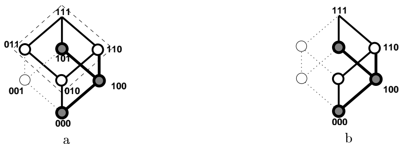
Figura 6.2: a) Os três intervalos após a extração de 001. b) Eliminação do intervalo [010, 111] que não será necessário na cobertura mínima.
