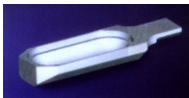
Figura 4 - Plataforma de grafite pirolítico utilizada em SS-ETAAS
