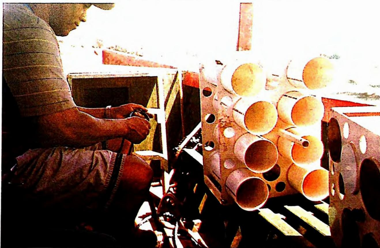
Figura 19: Coletor de sedimentos em suspensão.
