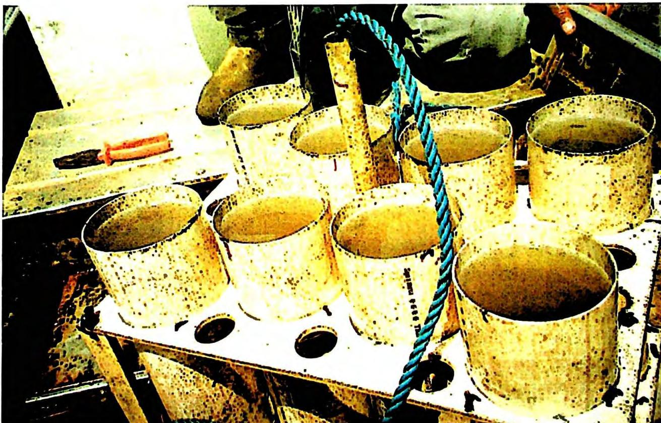
Figura 21: Coletores de sedimentos em suspensão colocados no ponto P2, em Rasgão.
