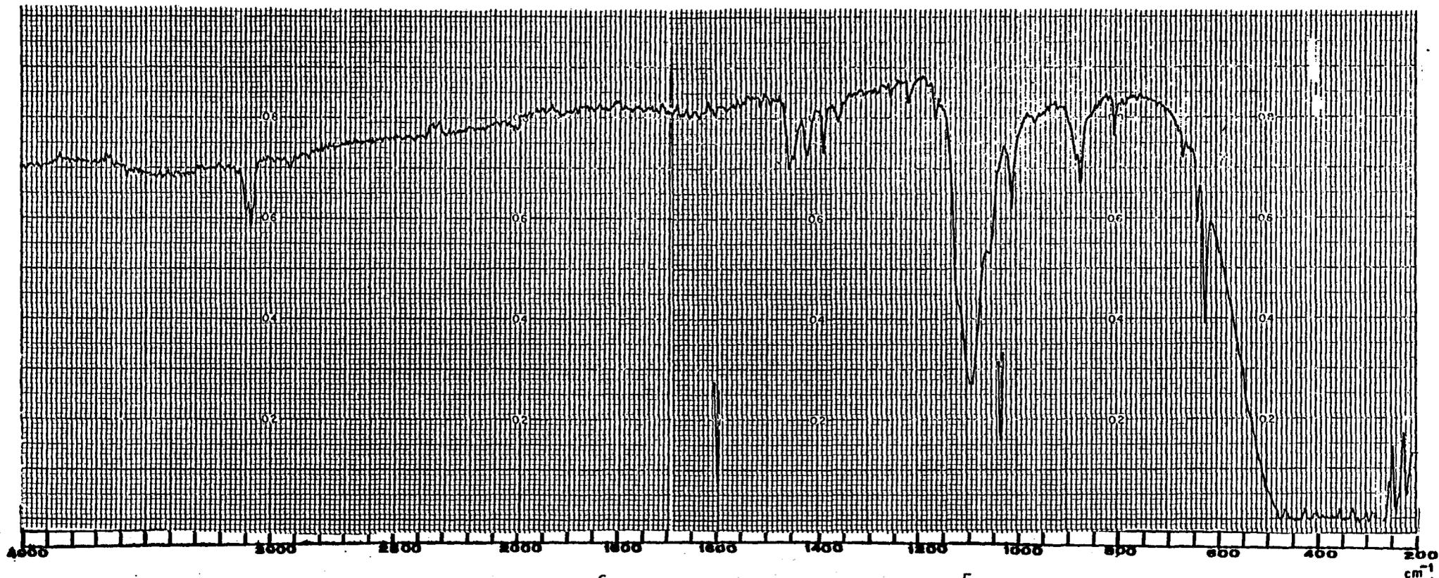
Espectro de IV de perclorato de  $(\eta^6\text{-1-cloro-4-metilbenzeno})(\eta^5\text{-ciclopentadienil})\text{ferro (II)}$
