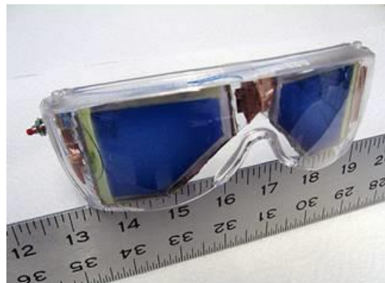
Figura 13: Protótipo de óculos composto de materiais eletrocrômicos.
