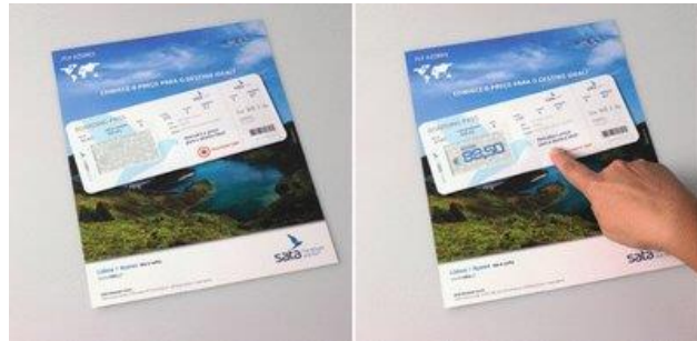
Figura 12: Display eletrocrômico da Empresa portuguesa Ynvisible, [46].
