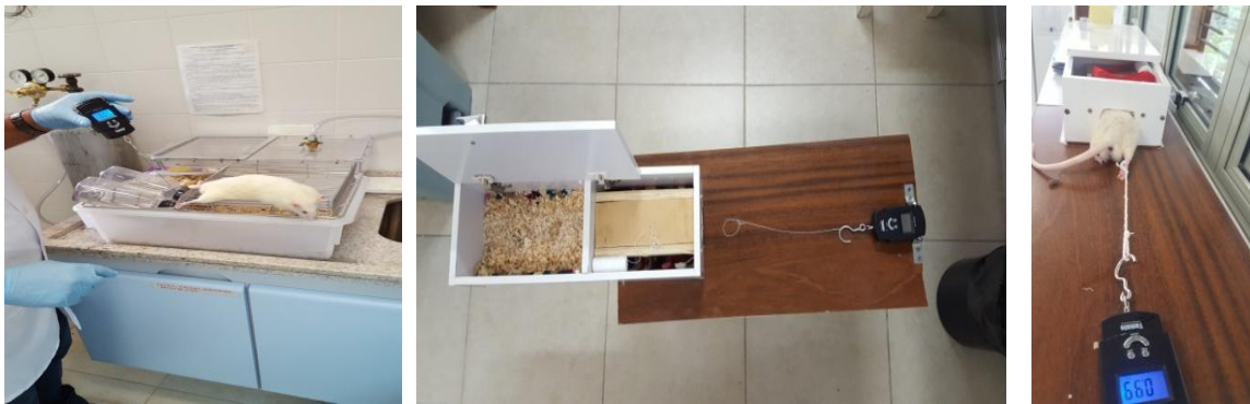
FIG. 18: Utilização de dinamômetro: E a construção de aparato de fuga acoplado ao dinamômetro para medição da força de tração.
