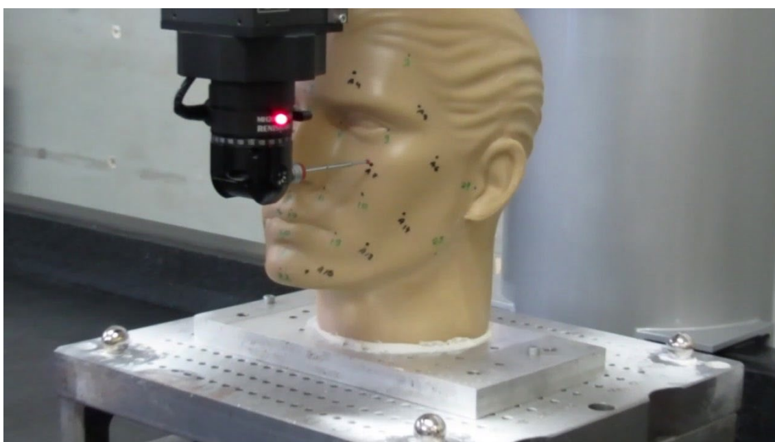
Figura 17 – Medida da cabeça pela CMM.
