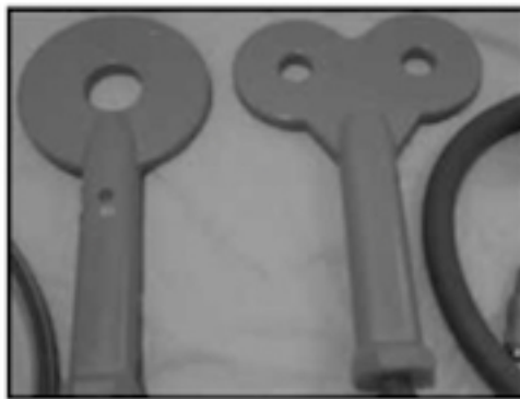
Figura 2. Bobina circular (esquerda) e bobina em oito (direita).
