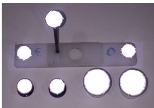
Figura 4 - Marcadores passivos retro-reflexivos
