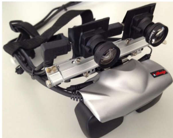
Figura 5 – Modelo de head-mounted display para gravação dos membros e exibição do membro espelhado via realidade aumentada. Fonte: Trojan et al. (2014) .
