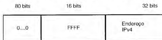
Figura 9: Estrutura do endereço IPv6- IPv4 mapeado
