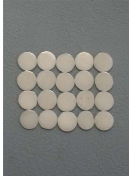
**Figura 15** – Corpos de prova de cerâmica polidos
