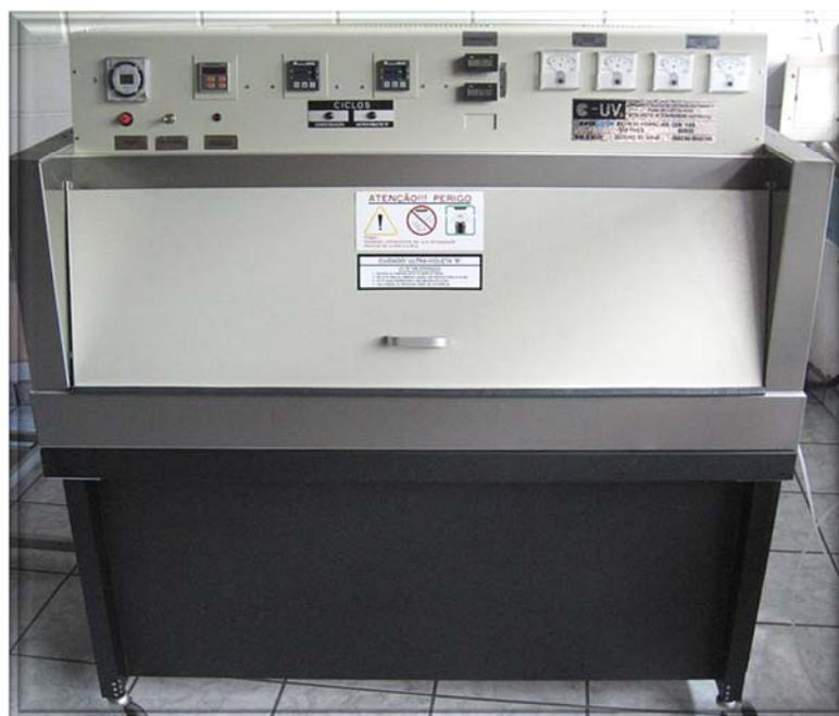
**Figura 37-** Máquina de Envelhecimento Artificial Acelerado
