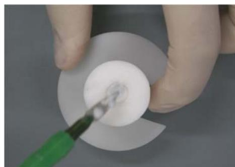
**Figura 11** - Inserção da cerâmica na matriz de teflon
