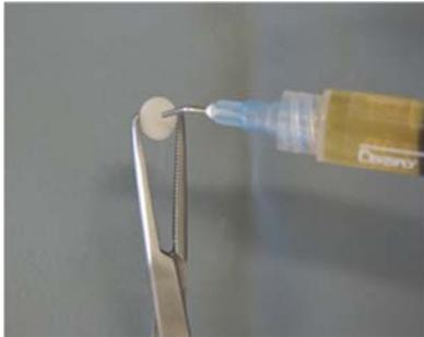
**Figura 20** - Aplicação do Ácido Fluorídrico 10%
