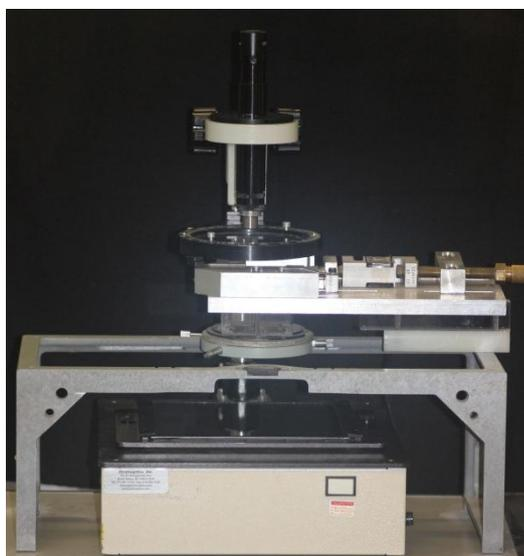
**Figura 16** - Polariscópio.
