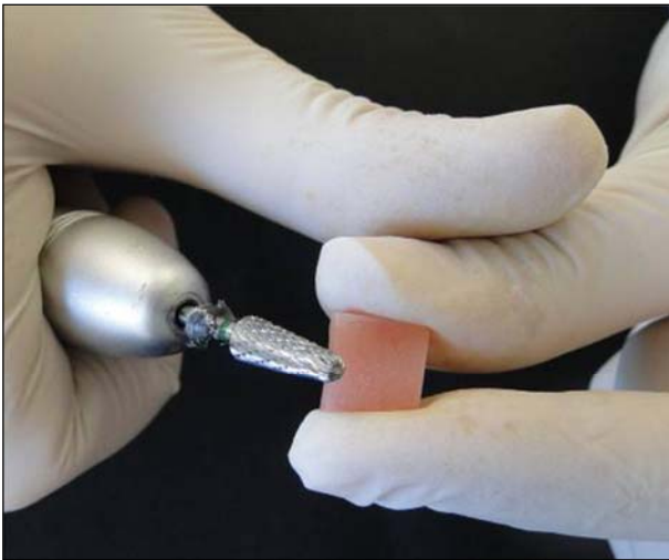
Figura 8. Acabamento dos corpos de prova com fresa.
