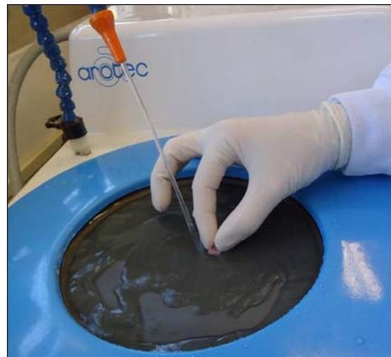
Figura 9. Polimento dos corpos de prova em politriz.
