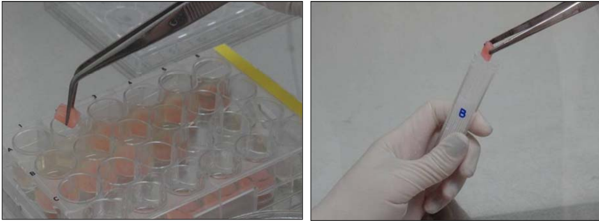
Figuras 18 e 19. Transferência dos corpos de prova contaminados para meios de imersão.
