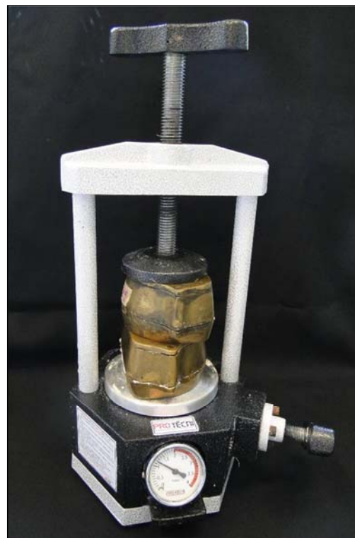
Figura 6. Posicionamento das mufas em prensa hidráulica.
