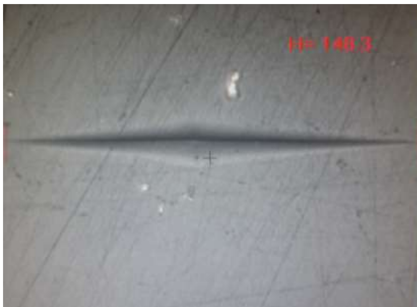
Figura 8. Representação da marcação feita pela ponta do microdurômetro.
