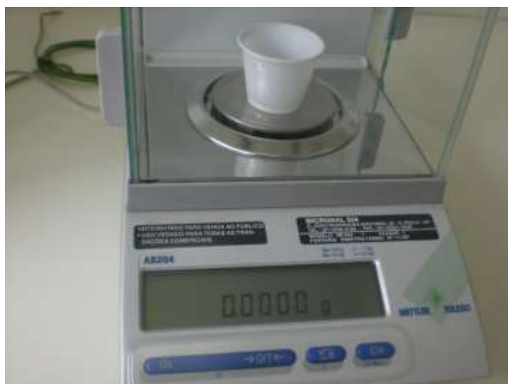
Figura 2. Pesagem da resina acrílica e do polipropileno.
