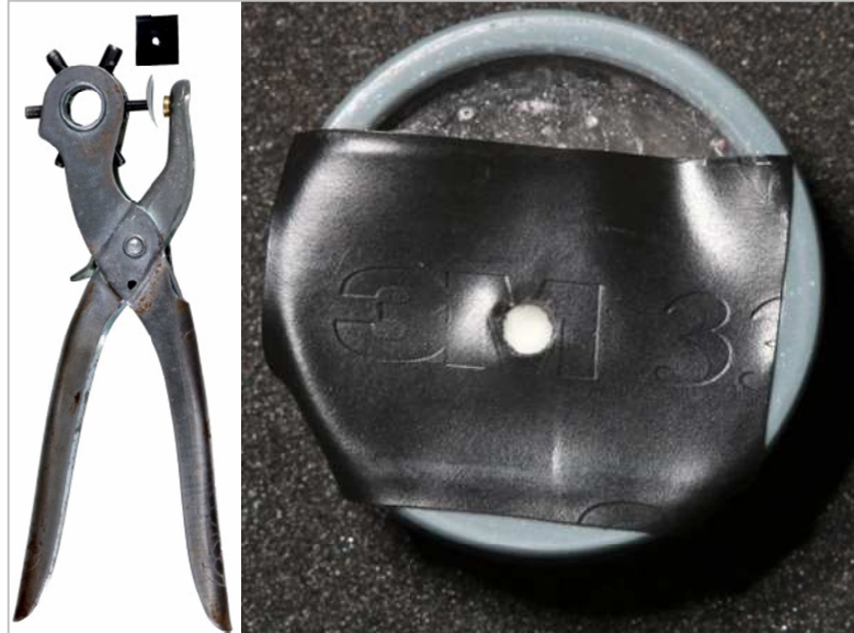
Figura 11 - Perfurador de lençol de borracha modificado e fita isolante com orifício posicionada no corpo de prova.
