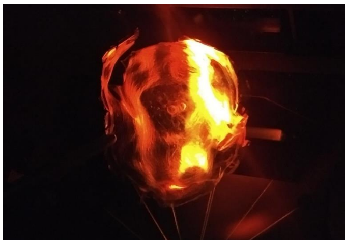
Figura 35. Imagem do filme LAGG_Eu1.0_TTA1 ilustrando a luminescência característica da emissão do complexo \text{Eu}(\text{TTA})_3 no filme quando irradiado com um feixe de luz de comprimento de onda relativo à absorção do complexo.
