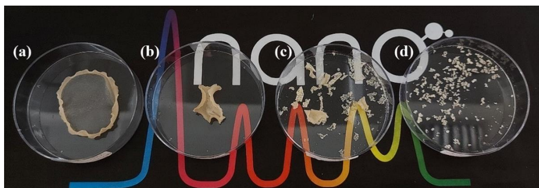
Figura 27. Foto dos materiais de LAGG dopados com \text{Eu}^{3+} preparados mantendo o volume de água igual a 10 mL. Amostras (a) LAGG_Eu2.0 , (b) LAGG_Eu3.0 , (c) LAGG_Eu4.0 e (d) LAGG_Eu5.0 .
