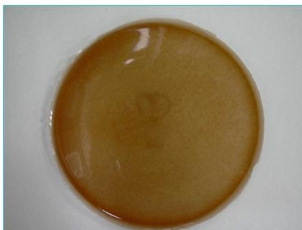
**Figura 100.** Foto do filme de silicone encapsulado com o complexo  $(Ru(bdqj-COOH)(terpy)NO)^{3+}$ .
