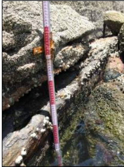
Figura 6 – régua para medição da anomalia de maré.
